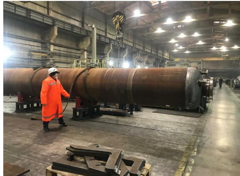
Вид изготовленного узла обеззараживания/карбонизации без теплоизоляции и обвязки
